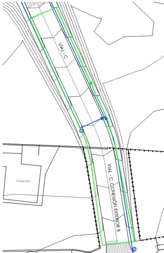
Por último, para el vial B, se instalará una red principal en PEØ50mm que recorrerá el vial desde la rotonda hasta su extremo oriental. A lo largo de esta red, irán instalándose ramales de goteo a cada uno de los ejemplares de Washingtonia Robusta instalados.
