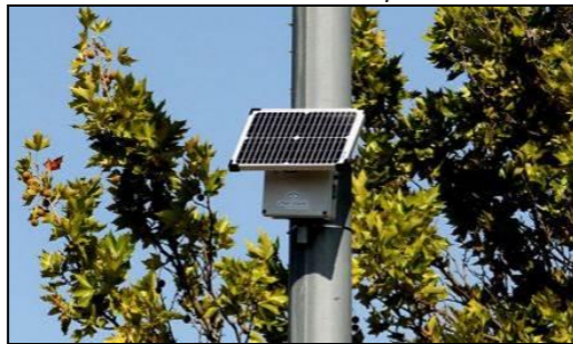
Ilustración 99: Estación para medir las sustancias contaminantes presentes en el aire.
