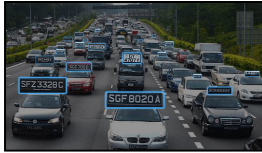
Ilustración 78: Ejemplo de funcionamiento del Sistema de reconocimiento automático de Placas de Matrícula por cámaras.
