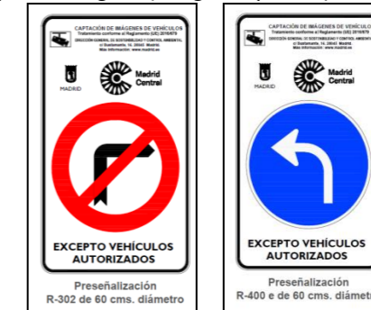
Ilustración 82: Ejemplos de señales de prohibido girar (imagen izquierda), o de giro obligatorio (imagen derecha).
